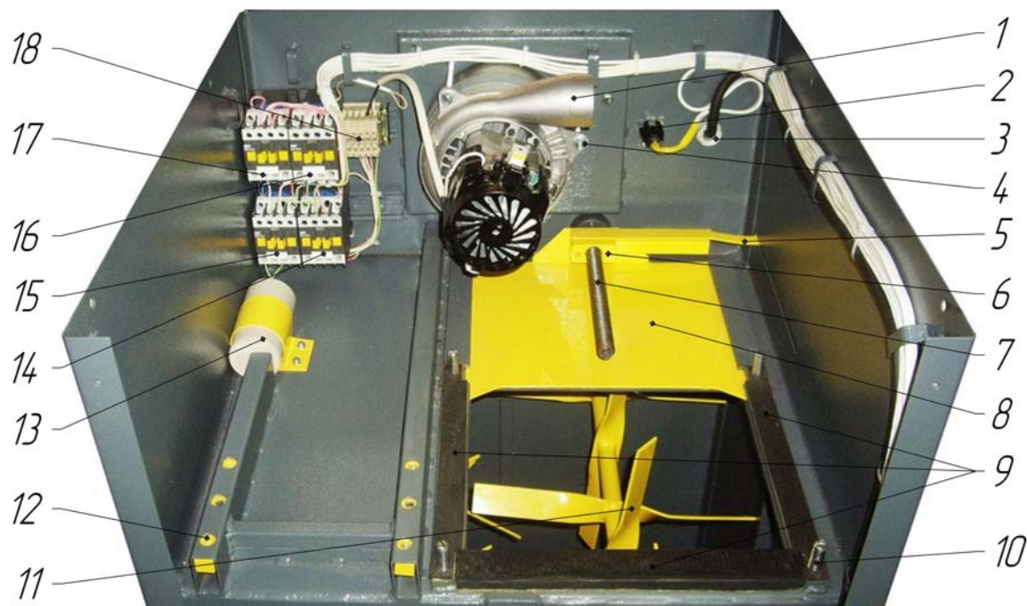
Рисунок 1.4.8 Рабочий отсек со снятыми питателем, мотор – редуктором и защитной крышкой блока автоматики
